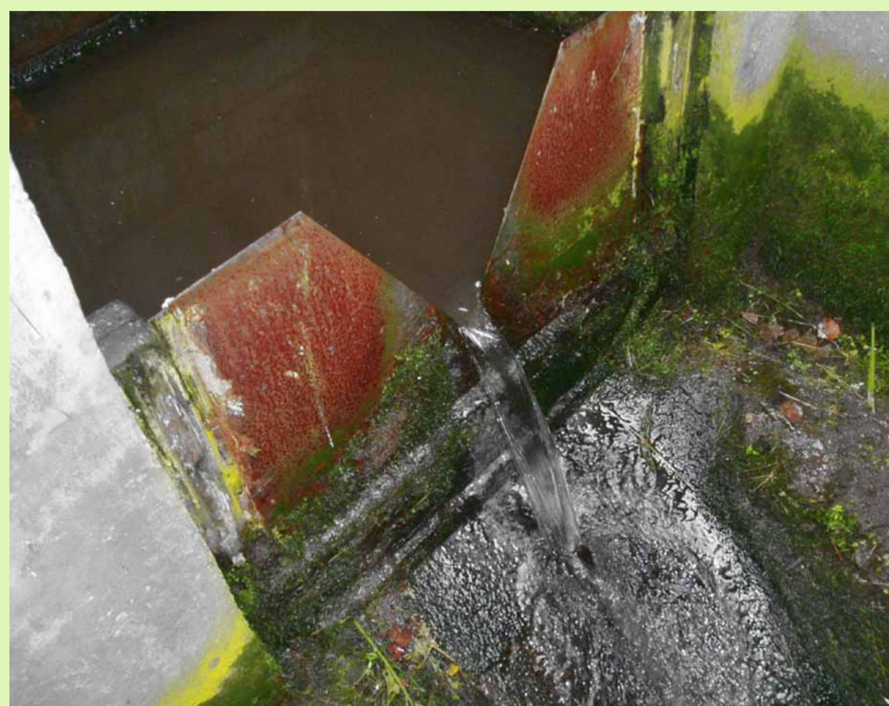
Obr. 2 Ostrohranný trojúhelníkový přeliv – instalován v betonovém žlabu, konstrukce celokovová (ocelový plech tloušťky 5 mm), v provozu cca 10 let. ( www.pars-aqua.cz/prelivy.html )
