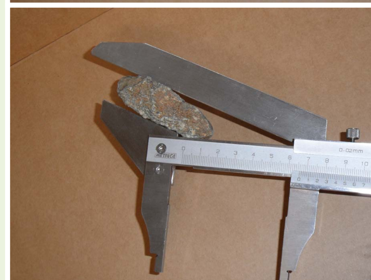
Zrno projde. Tvarový index větší než 3 – tvarově nevhodný
